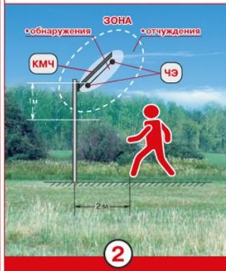
ВАРИАНТЫ УСТАНОВКИ ЧУВСТВИТЕЛЬНЫХ ЭЛЕМЕНТОВ (ЧЭ)
