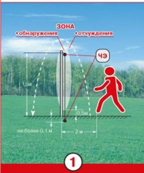
ВАРИАНТЫ УСТАНОВКИ ЧУВСТВИТЕЛЬНЫХ ЭЛЕМЕНТОВ (ЧЭ)
